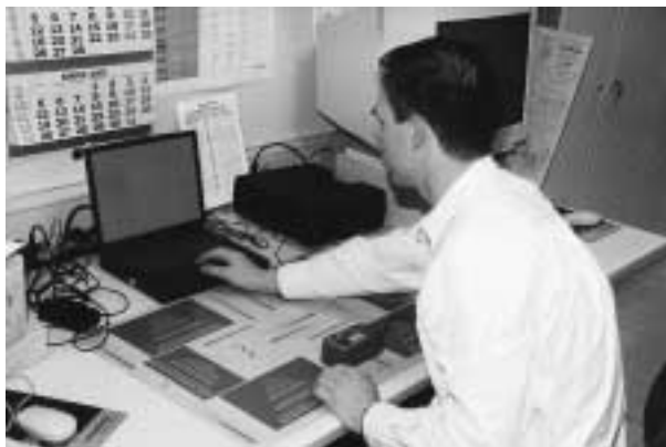
Bild 4: Das Videomikroskop Techkon DMS910 beim Messen auf der Platte.
