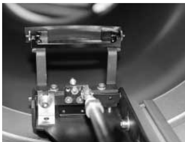
Bild 11: Die Steuerung für das Herunterklappen des Filmhalters ist bereits in die Belichtersoftware des DMX 2737 integriert.
