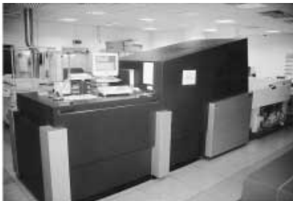
Bild 8: In dieser CTP-Produktionslinie im „Darmstädter Echo“ wurde das Konzept eines Kontrollsystems erprobt. Die Linie besteht aus dem Belichter Purup-Eskofot DMX 2737 (hier wurde die Vorrichtung zur Positionierung eines analogen Graukeils im Versuch installiert) dem Online-Prozessor Glunz & Jensen Interplater 85HD und dem Stanz- und Abkantautomaten NELA VCP2002.
