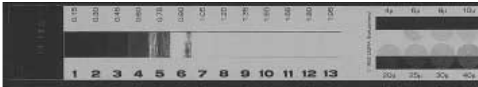
Bild 2: UGRA/FOGRA Keil 1982 zur Kontrolle der Aushärtung einer Platte. Die 3. Stufe muß gedeckt sein (AGFA N91).
