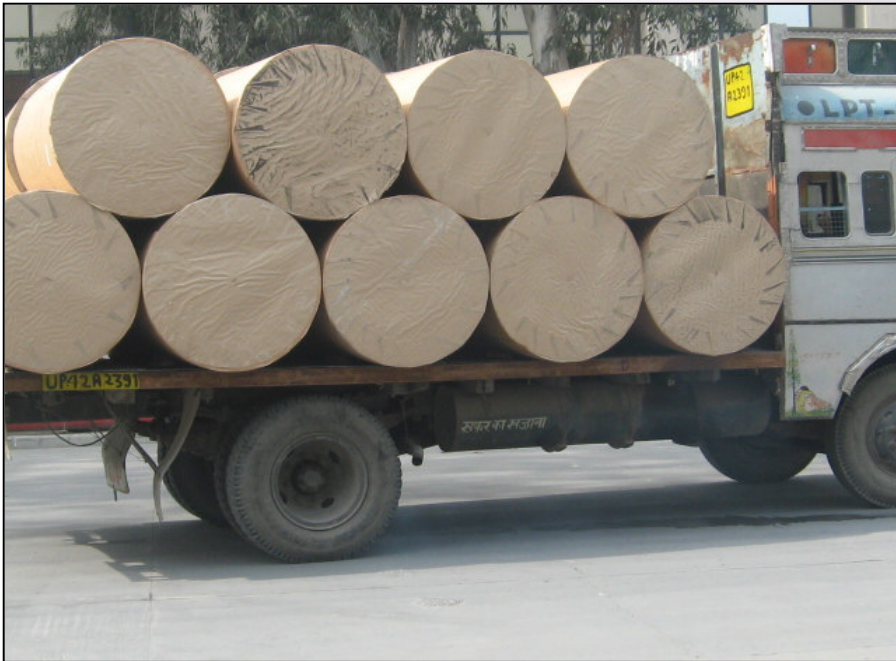
Double layer loading (18 reels)
